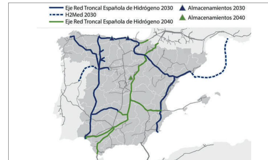
Está prevista la construcción de más de 3.000 km de tuberías para la distribución del hidrógeno por la península.
